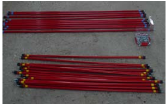
Tiges longues «jaunes», diagonales «bleues» et boîte d'écrous, papillons, boulons et mousquetons
