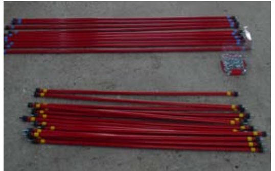
Tiges longues «jaunes», diagonales «bleues» et boîte d'écrous, papillons, boulons et mousquetons
