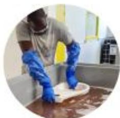
Les céramiques sont alors nettoyées et détartrées dans différents bains de trempage, puis débarrassées des résidus de silicone.
